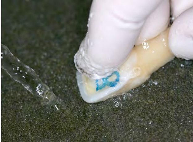
Abbildung 8: Beschleifen der Zähne auf Sandpapier
