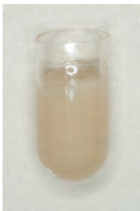
Abbildung 9: Eine zu \frac{2}{3} mit Komposit befüllte Gelatinekapsel
